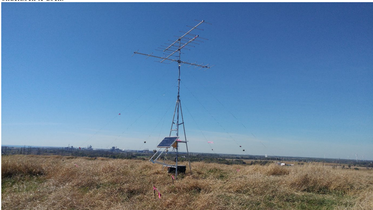
Motus ontvangststation op een kale heuvel geplaatst. De mast heeft 3 directionele antennes (type 'oude televisieantenne').
